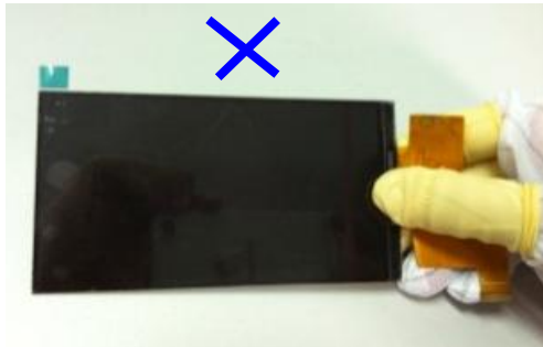
Please don't hold the surface of IC 请不要拿着 IC 的表面
